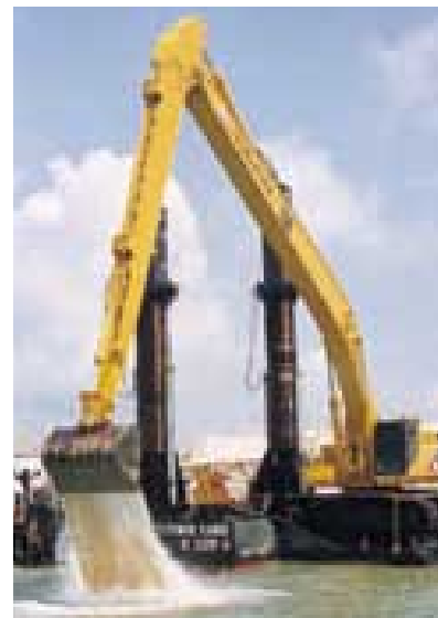
The Caterpillar 375 Hydraulic Excavator features a super long arm Jengkaut Hidraulik Caterpillar 375 memaparkan jangkauan yang lebih panjang
